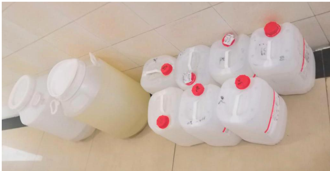
3-4304 门外走廊 放置废液桶均未贴标签，其中有存有废液但未盖紧的情况。
